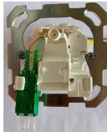
Lato superiore con 1 LC / APC (figura 3)
