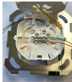
Variante con 2 pigtail (figura 5)
