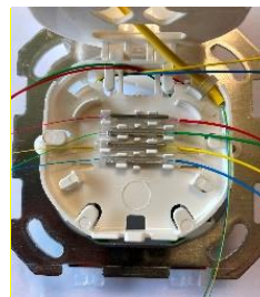
Variante avec 4x Pigtails (image 6)
