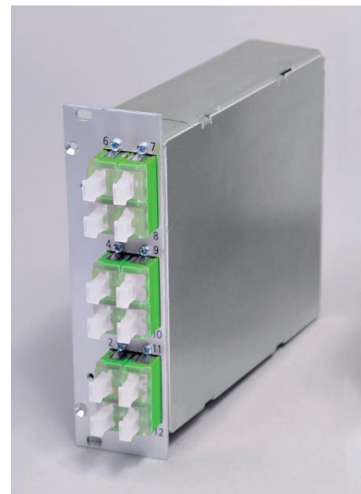
3HE/7TE Einschub bestückt mit: Frontseite 6x LC/APC Quad Rückseite 1x MTP/MPO
