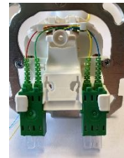
Oberseite mit 2x LC/APC (Bild 4)
